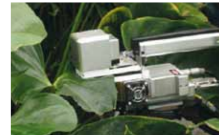
Medición de la fotosíntesis en un Anthurium
